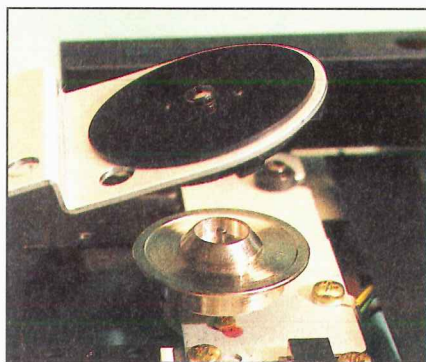
La meccanica del DP-1000 è molto sofisticata; nella foto un particolare del «piatto», e del centratore/stabilizzatore.
